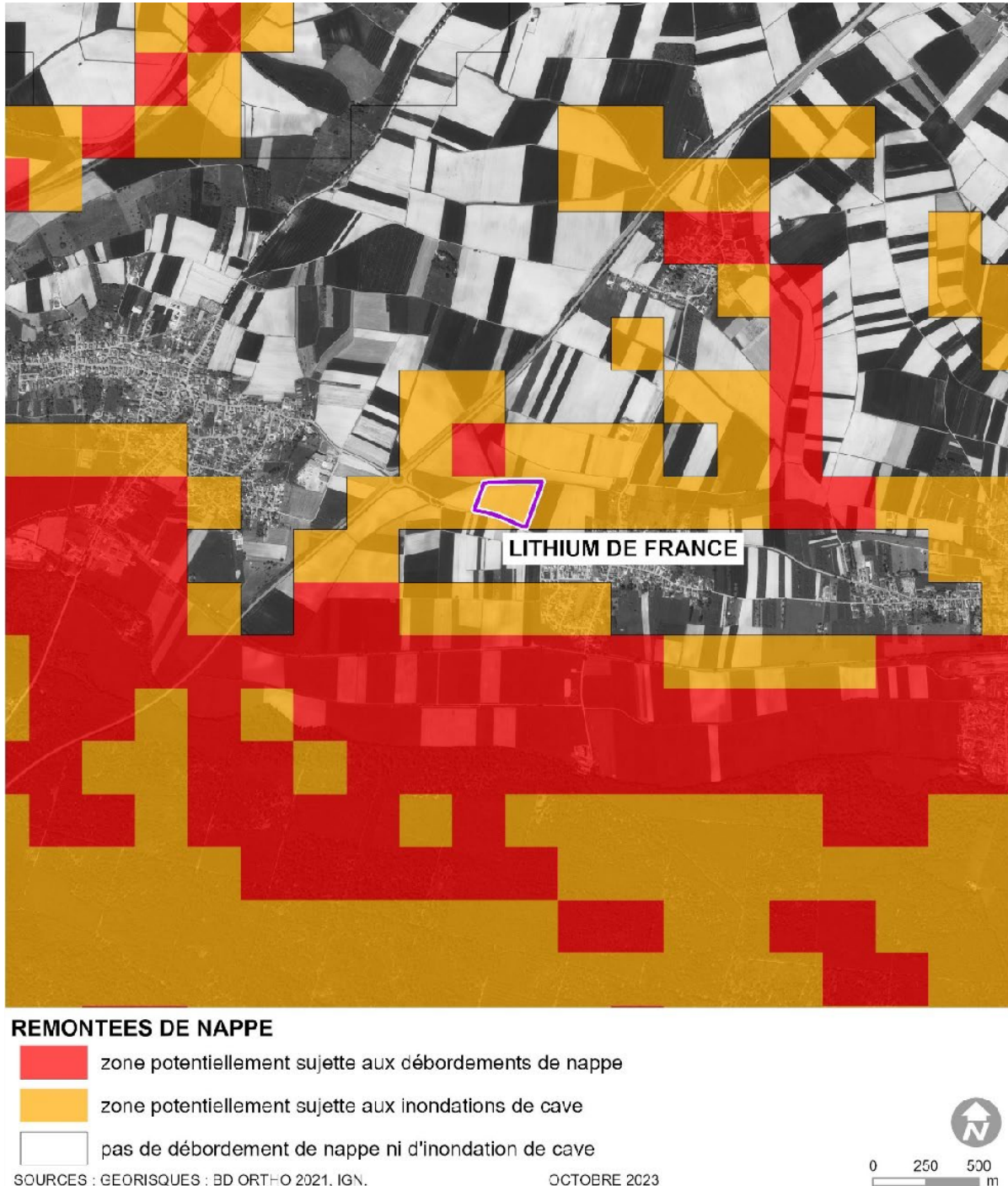
Remontées de nappe identifiées dans le secteur d'étude
